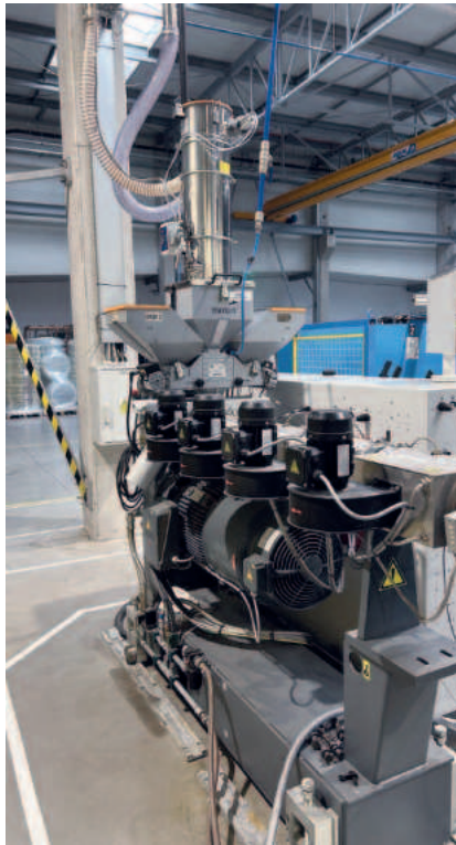
Ein MINICOLOR V Synchron-Dosiergerät versorgt einen weiteren Extruder mit Material. Die seitlichen Dosierstationen ermöglichen es, 2 Komponenten präzise zur Hauptkomponente zu dosieren
