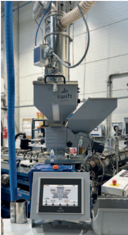
Das Synchron-Dosiergerät sBLEND V der swift-Baureihe sitzt direkt auf dem Extrudereinlass. Beschickt wird es mit einem METRO G Systemfördergerät
