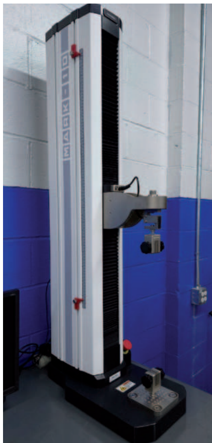
Zugtestanlage in der Extrusionsanlage
